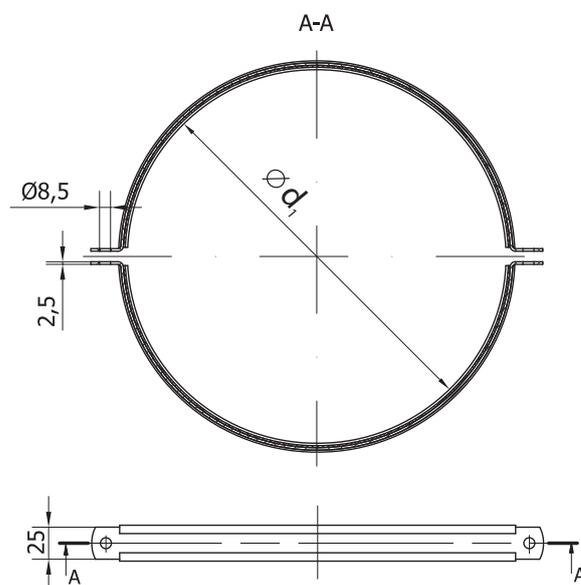
\* Die Schellen ab  $d_1 \geq 450$  werden ohne Nieten gefertigt und an zwei Gewindestäben aufgehängt.
